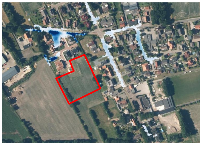
Figuur 4.11: Klimaat-effect atlas, waterdiepte bij 70 mm neerslag in 2 uur
