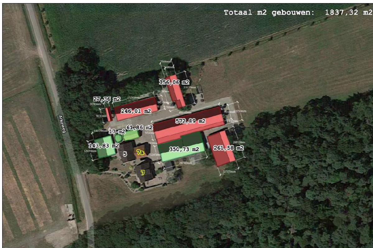
Afbeelding 3.2 Overzicht te slopen (rood) en te behouden (groen) schuren aan de Arkeweg 5-7 (Bron: initiatiefnemer)
