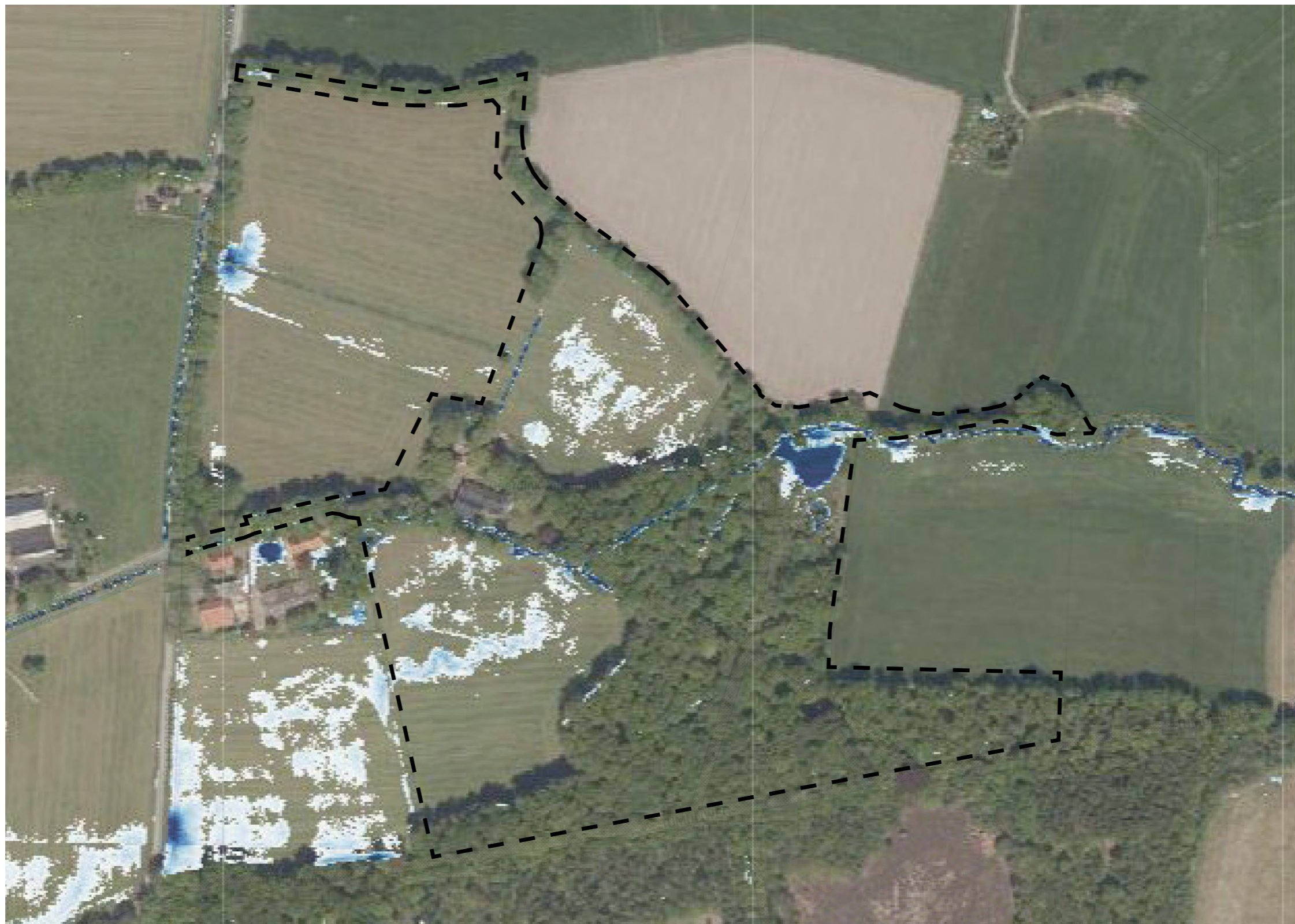
Plangebied wat onder water staat na een bui van 160mm in 48u. Opmerkelijk is dat het plangebied redelijk droog is. Dit zou kunnen komen door de hoge ligging (weinig aanvoer regenwater achterland). Het gebied watert snel af richting het westen door het hoogteverval. (bron: https://tw.n.klimaatatlas.net/ )
