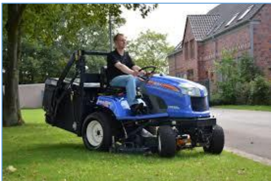
Figuur 3.5 wadi's worden wekelijks gemaaid en het maaisel wordt opgevangen en afgevoerd bron: terstegetuinmachines
