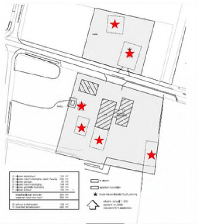
Locatie 1. De te slopen gebouwen worden met de rode ster aangeduid.
